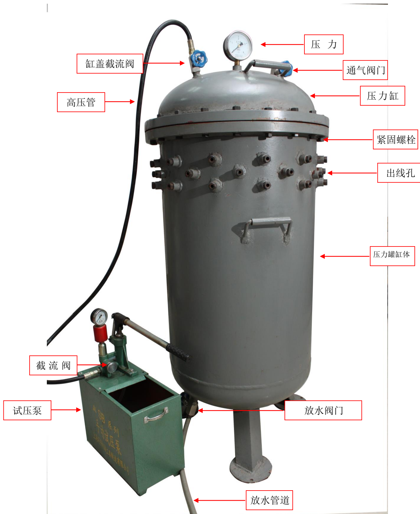
图 2：下图为水压罐各部位名称标示
